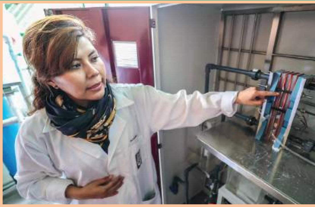
👍 Issis Claudette Romero Ibarra, investigadora de la UPIITA, muestra el método de electroionización en el que a través de un conjunto de membranas se separan los iones de metales pesados del agua a purificar
