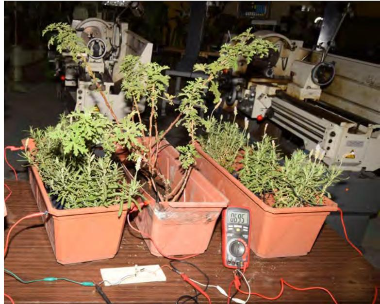
▶ Para crear este prototipo se conectaron cuatro macetas en serie para conformar una celda productora de energía eléctrica que ilumine un espacio con cuatro diodos led
