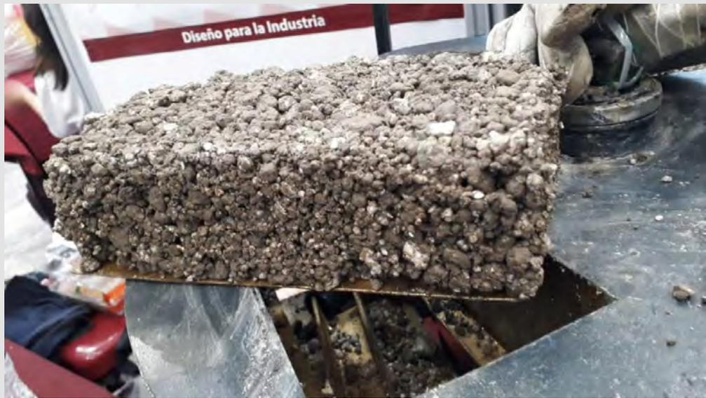
Para la elaboración del tabicón, los estudiantes del IPN construyeron una máquina compactadora que realiza mezclado, compactado y desmoldado
