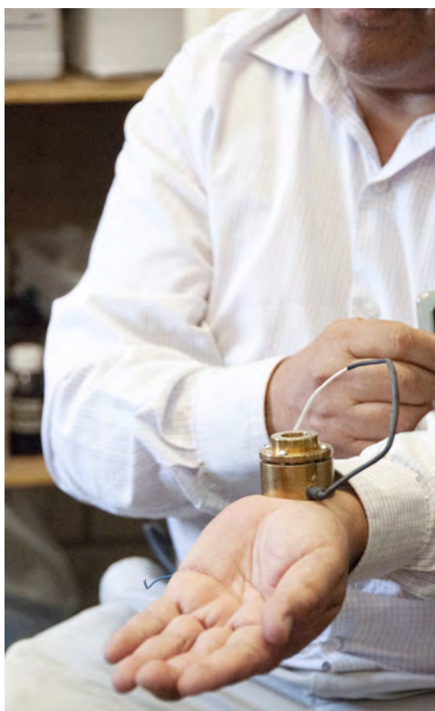
El experto de la Upibi también realiza la técnica fotoacústica para medir la glucosa en sangre, la cual consiste en colocar una celda fotoacústica en la muñeca del brazo u otra parte del cuerpo
