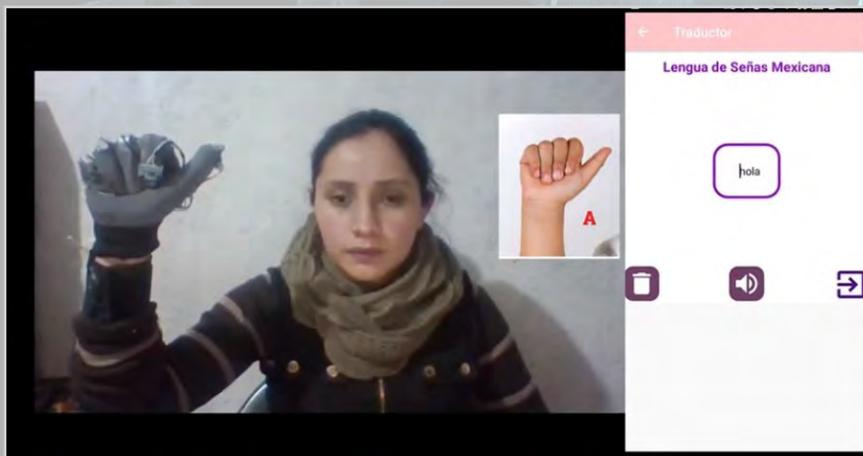
El prototipo identifica los movimientos de las manos de la Lengua de Señas y las envía a un dispositivo móvil para que se muestren en pantalla las letras hasta formar palabras
