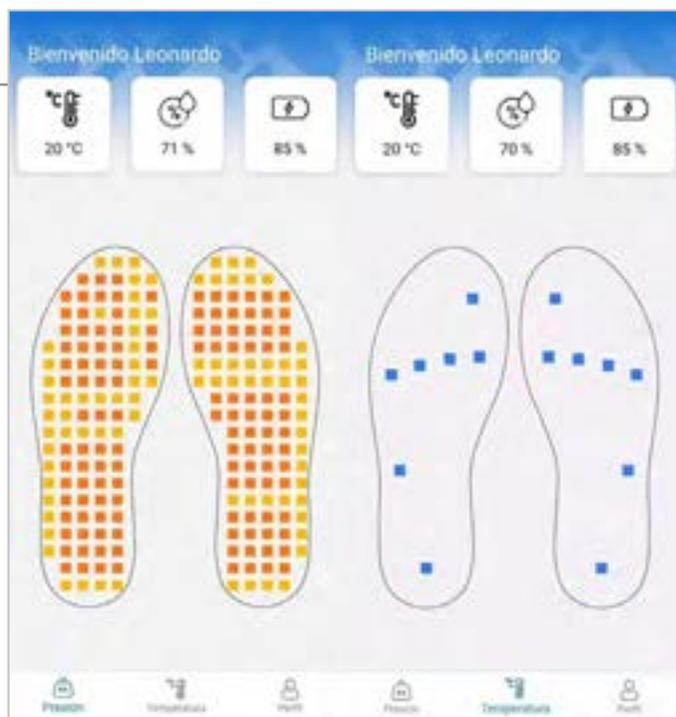
Se trata de un prototipo de plantilla instrumentada con diversos sensores para monitorear el microclima del pie dentro del zapato
