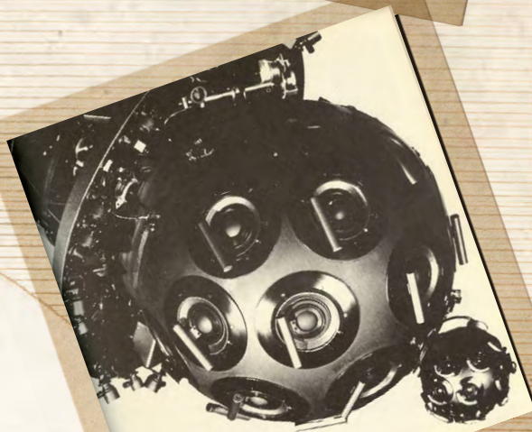
➤ Aspecto del proyector marca Carl Zeiss, modelo Mark IV, con el que inició sus actividades el Planetario
