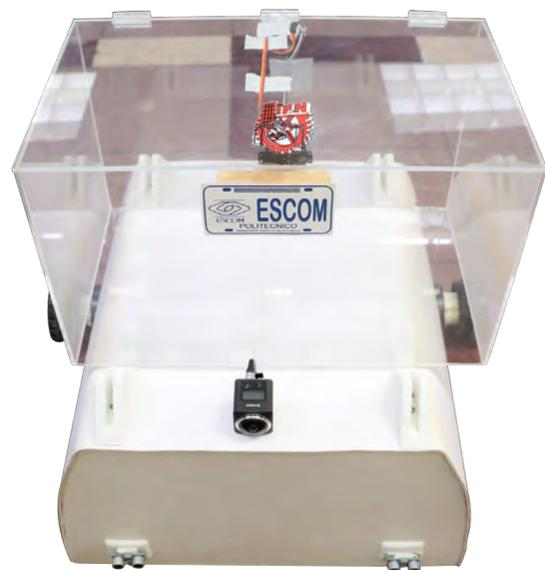
👍 El robot cuenta con una "caja de seguridad" de acrílico transparente para trasladar documentos y paquetes
