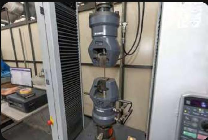
Medidor de resistencia de materiales
