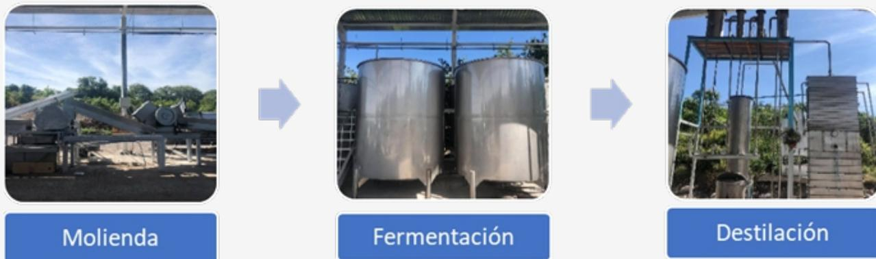
**Figura 2** Proceso de obtención de Aguardiente de Caña de Azúcar en planta Piloto.
