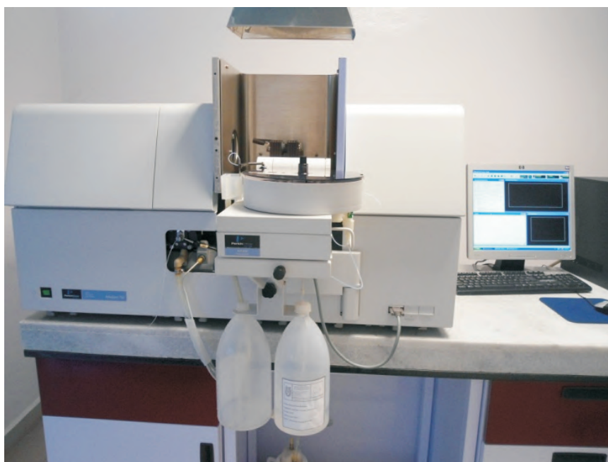
Figura 1. Equipo de EAA para determinación de metales pesados en la CI
