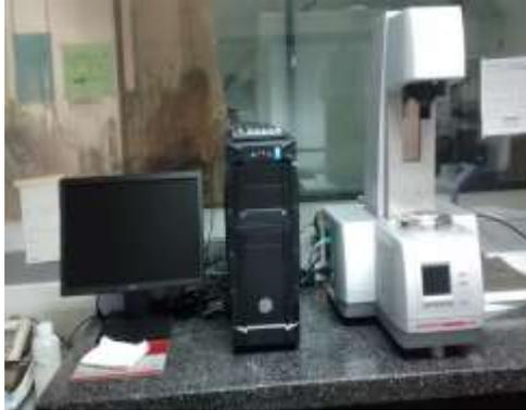
**EQUIPO: DETERMINACIÓN DE TEXTURA DE BIOMATERIALES. TEXTUROMETRO X2TI**
