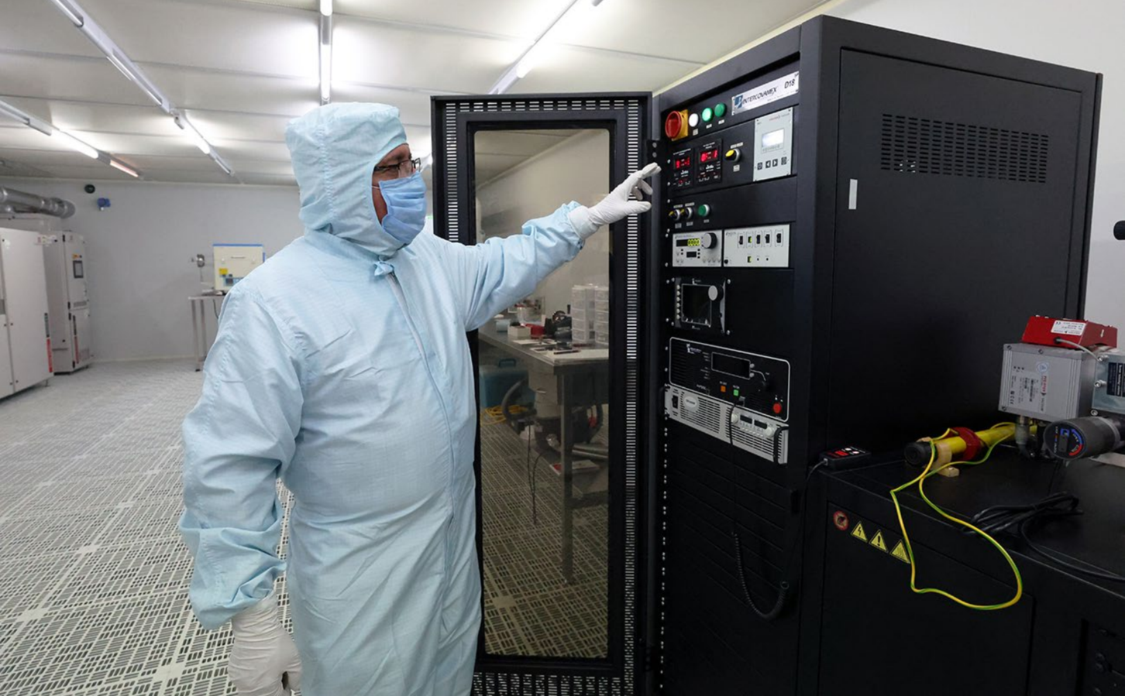
El LNunT alberga un Cuarto Limpio Clase 100 (ISO 5), con áreas blanca y amarilla para realizar el diseño o elaboración de semiconductores
