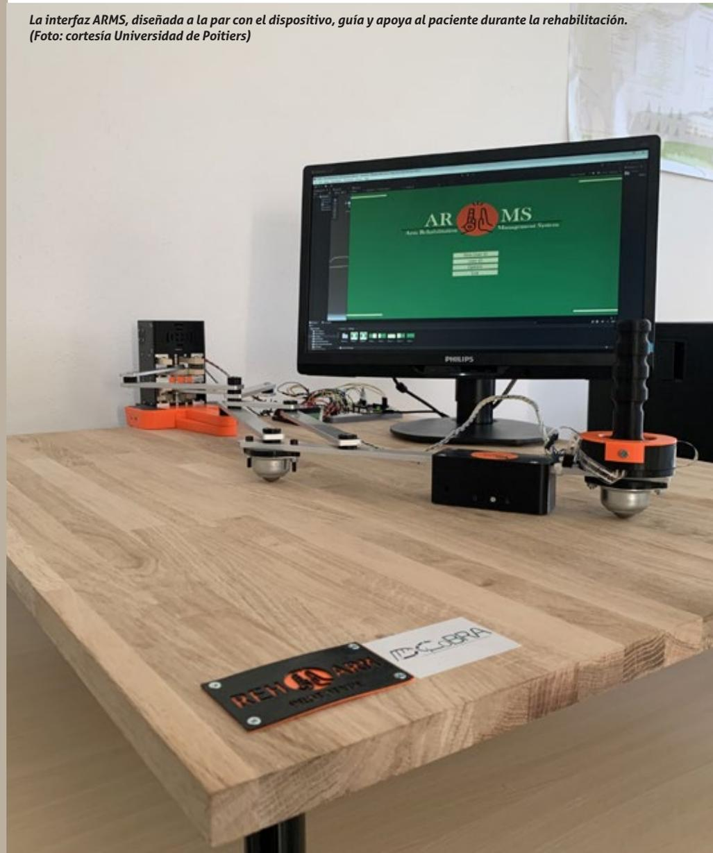
“El artefacto consta de los siguientes módulos: un sistema que incluye dos articulaciones de rigidez variable simétricas, abrazaderas de mesa, un mecanismo de cinco barras, un pantógrafo, una carcasa para ratón que permite la comunicación y traducción instantánea de los movimientos del paciente a la interfaz y una empuñadura”, externó el docente de la Universidad de Poitiers.
