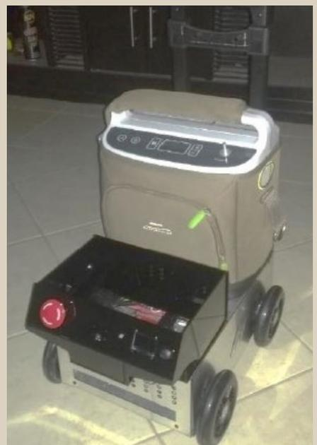
**El dispositivo es capaz de trasladar un concentrador de oxígeno portátil de cuatro kilogramos**
