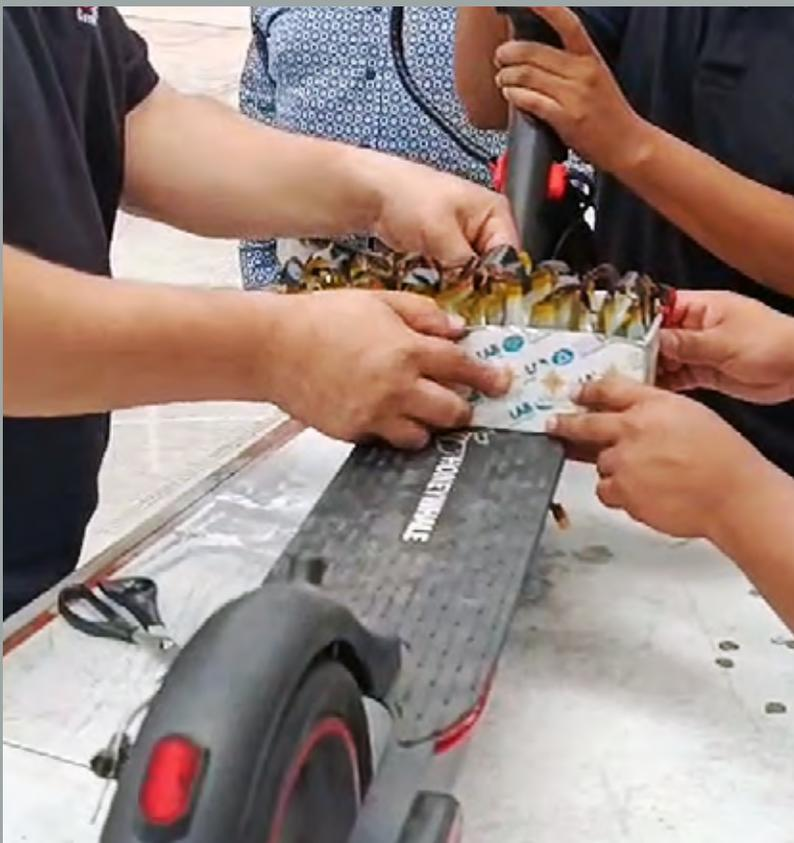
Instalación de baterías de Litio en scooter
