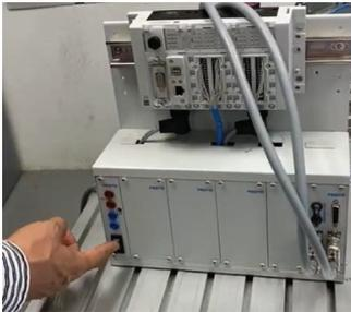
**Figura 1A** Interruptor de encendido del PLC.
