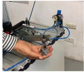
**Figura 1I** Alimentación de aire comprimido.
