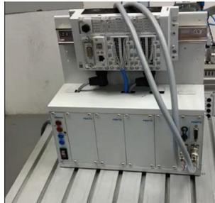
**Figura 1B** Fuente de alimentación del PLC.
