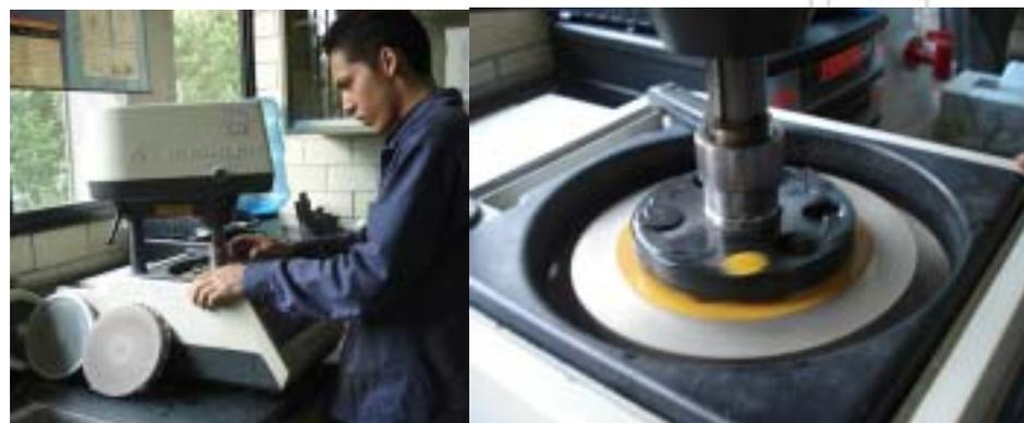
Preparación Metalográfica de Muestras con Método Semiautomático 20
