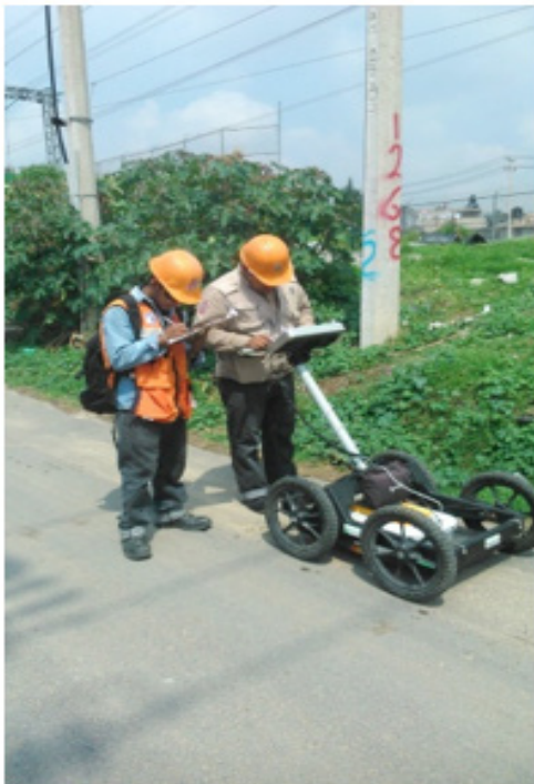
Estudio de Georradar "Línea de Transmisión Aeropuerto, entronque Apasco-Las Julias".
