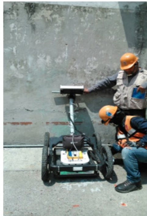
Estudio de Georradar "Línea de Transmisión Aeropuerto, entronque Apasco-Las Julias".
