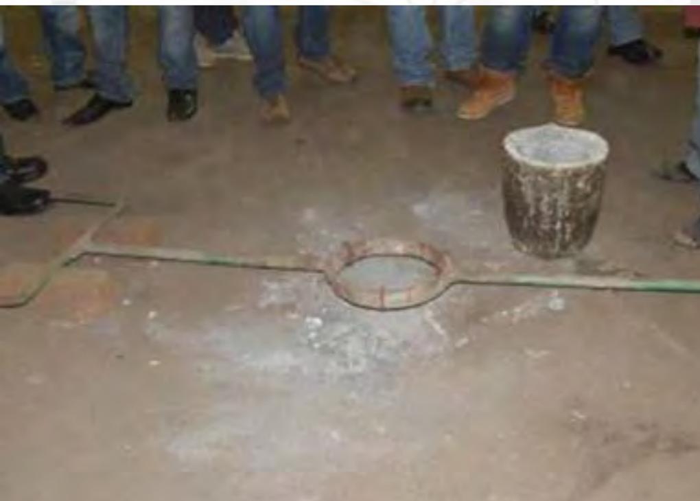
**Adaptación de Herramienta Manual para uso de Crisoles.**
