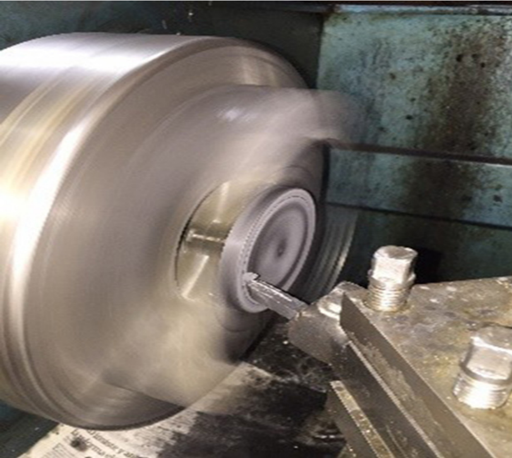
Manufactura de ánodo para la síntesis de nanotubos de carbono con múltiples defectos topológicos.
