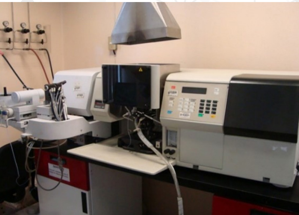
Servicio de Mantenimiento proporcionado a un Espectrofotómetro de Absorción Atómica del Centro Interdisciplinario de Investigaciones y Estudios sobre Medio Ambiente y Desarrollo (CIIEMAD).
