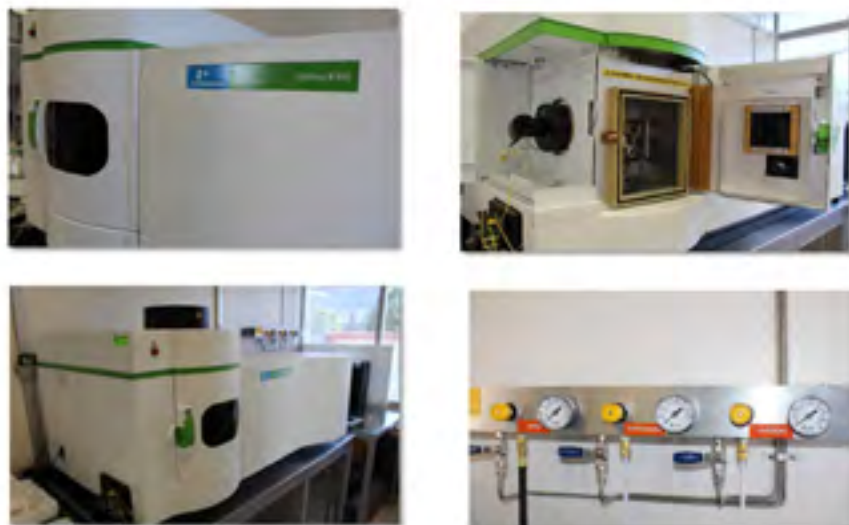
Fotos del espectrómetro de emisión de plasma acoplado inductivamente ICP Optima 8300 DV para el laboratorio del CIIEMAD
