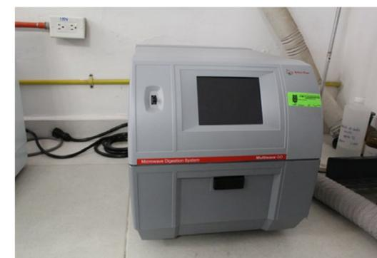
Horno de digestión por microondas Anton Paar
