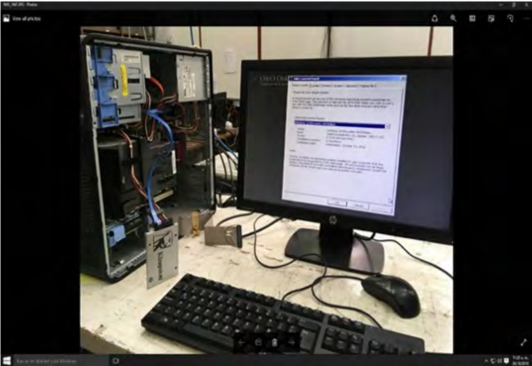
Clonación de discos duros en equipos de aula de profesores AS-400
