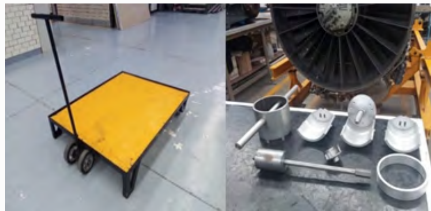
Plataforma para traslado y herramienta para motor JT8-D
