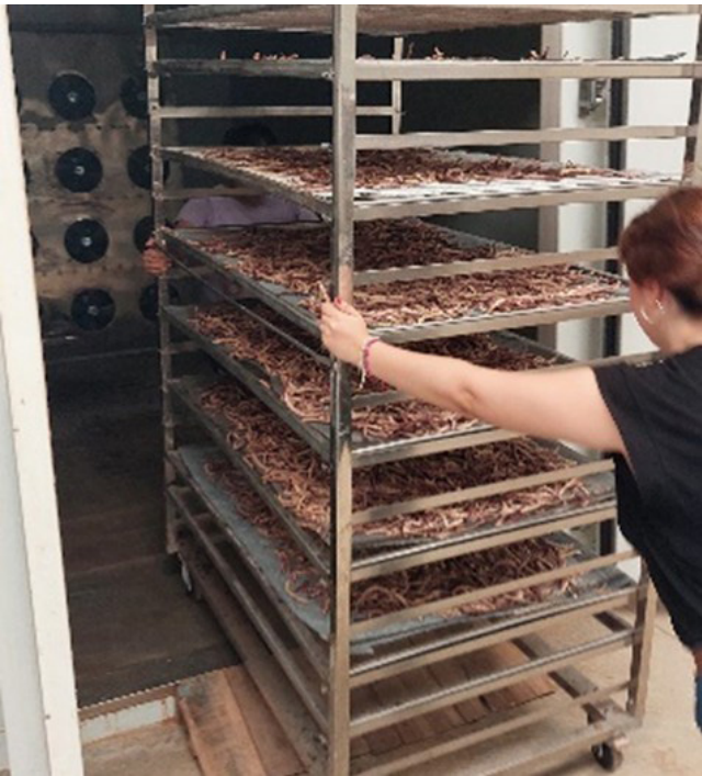
Proceso de deshidratación de mezquite en la cámara deshidratadora.
