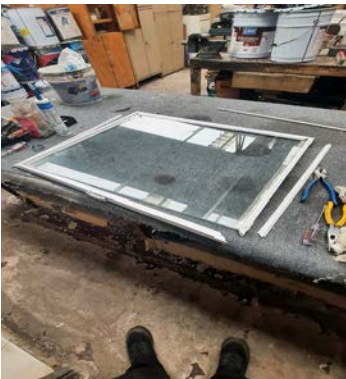
Mantenimiento a ventanas de PVC que se dañaron del marco.
