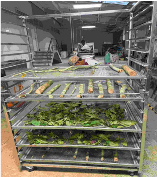
Preparación y acondicionamiento de muestras de material vegetal previo a su ingreso a la cámara de deshidratado.
